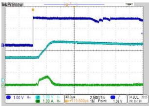
Load Transient (CH2=Vo,CH4=Io)
