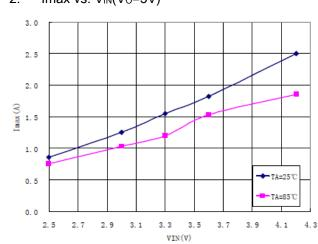
2. Imax vs. V<sub>IN</sub>(V<sub>O</sub>=5V)
